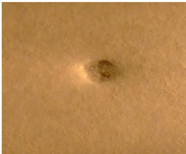
Figura 48 – Impressão Braille com placa de impressão em alto relevo redondo e espuma de vedação cobrindo todo o papel.
